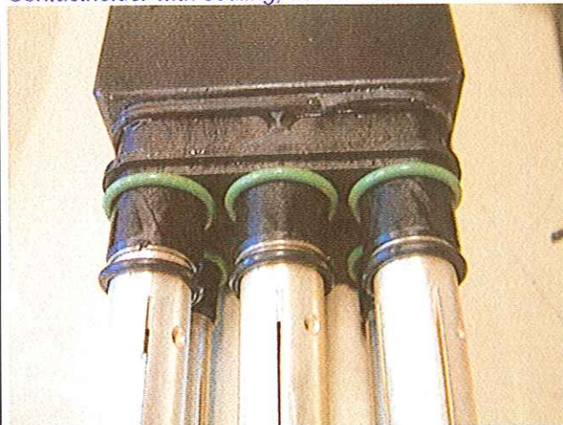
Foto 11 / Picture 11 Leistungskontakt Power contact
