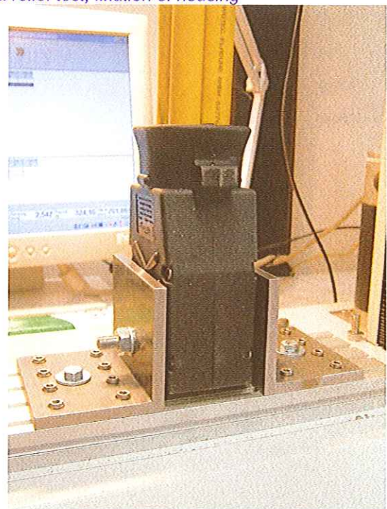
Foto 13.4 / Picture 13.4 Prüfung der Zugentlastung, Fixierung Gehäuse Pull relief test, fixation of housing
