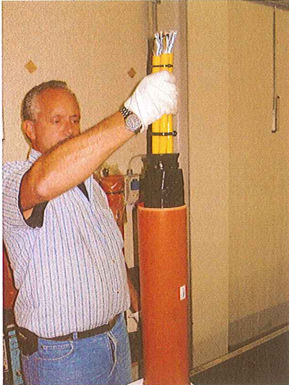
Foto 9.5 / Picture 9.5 Prüfliquid auf dem Prüfling Test fluid on specimen
