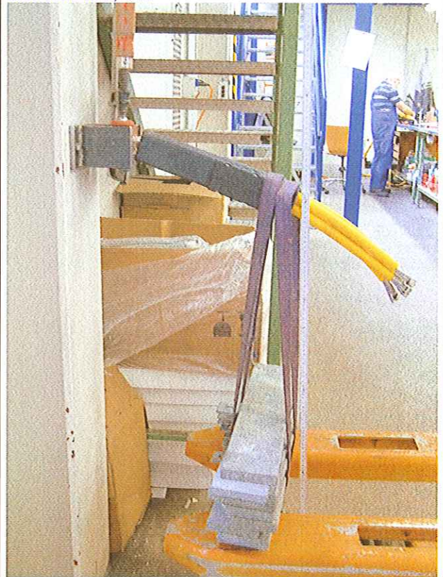
Foto 8.6 / Picture 8.6 Statisch Querlast, Ende Side load test, end
