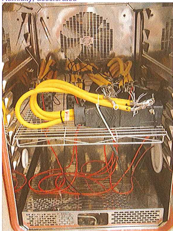
Foto 1.7 / Picture 1.7 Feuchte Wärme, beschleunigt Humidity, accelerated
