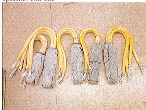
Foto 1.8 / Picture 1.8 Prüflinge nach Kältelagerung Specimen after cold
