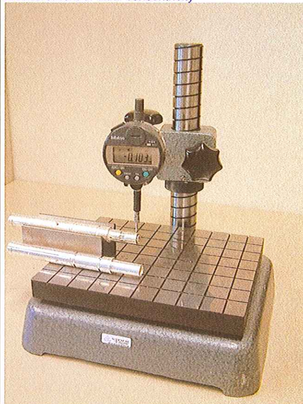
Foto 10.4 / Picture 10.4 Messung der Exzentrizität Measurement of axial concentricity
