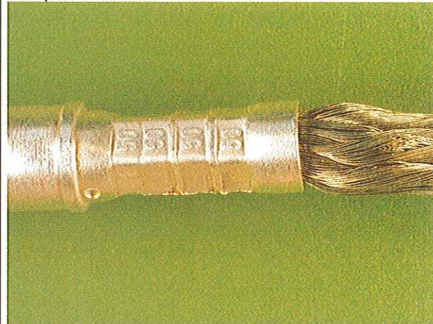
Foto 10.4 / Picture 10.4 Messung der Exzentrizität Measurement of axial concentricity
