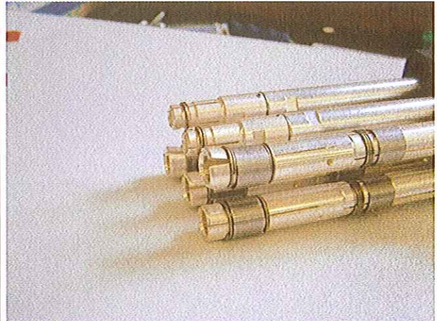
Foto 8.8 / Picture 8.8 Leichte Deformation des Kontakteinlaufs Minor deformation of the socket contacts
